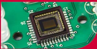
Le camera VGA est sur la base de CMOS capteur avec squalch , système de microlentilles, le traitement d'image basé sur un microprocesseur, LED ponctuel, filtre IR combiné. Tous ces critères donnent une image de haute qualité .
