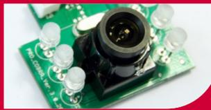
Objectif lumineux multicomposant avec vaste amplitude de vue (20mm f/2.8) permet détecter l'image complète du billet , même des grands billets et donne l'image profonde de surface du billet .
