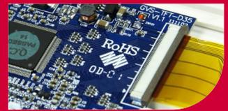
Le processus automatisé de production des plaques de fonction sur la base de technologie d'assemblage exempt de plomb (RoHS) permet d'obtenir la haute qualité de détecteur
